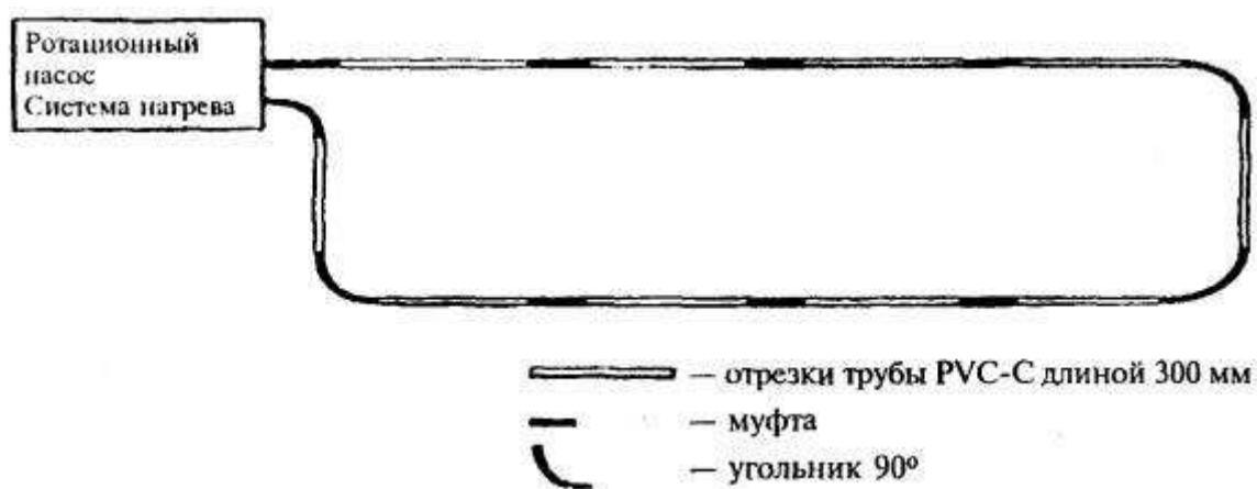
Рисунок 2 - Схема испытаний клеевых соединений труб и фитингов из PVC-C на стойкость к аварийной температуре Тавар
